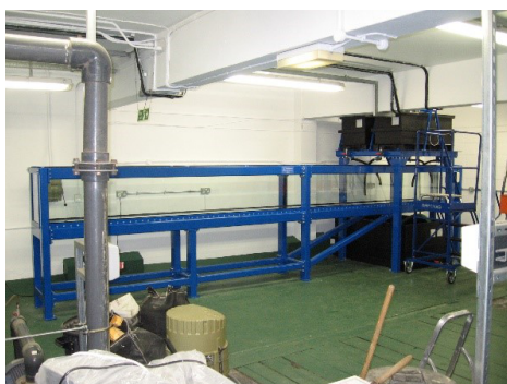
Kanał falowy typu CTO-WC-7/0,4/0,6 wykonanie
