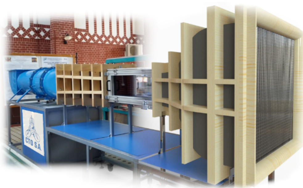
Edukacyjny tunel aerodynamiczny typu CTO-LSWT-C1/41/1/5,5
